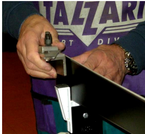
Affilatura del fianco della lamina
