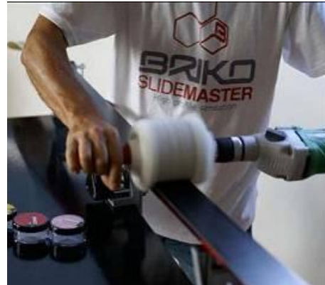
Pulitura della soletta con spazzola rotante.
