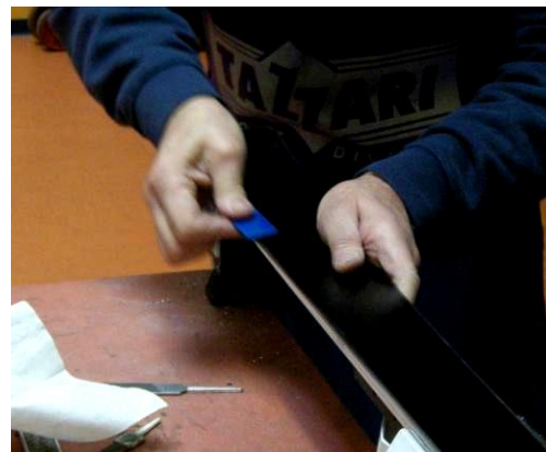
Finitura del tuning sulla lamina.
