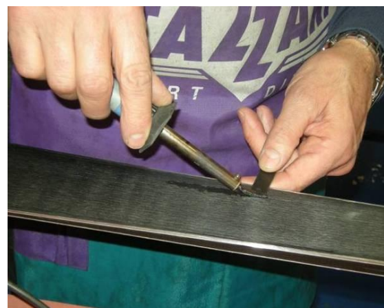
Riparazione della soletta con saldatore.
