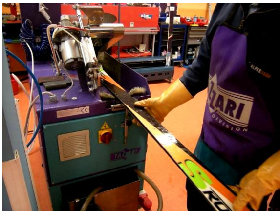
Passaggio dello sci alla mola a pietra.
