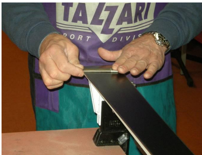
Tuning effettuato a mano con lima.
